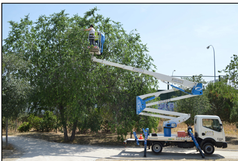
Imagen 46. Plataforma elevadora con la que se han llevado a cabo las inspecciones en copa de los distintos tratamientos.
