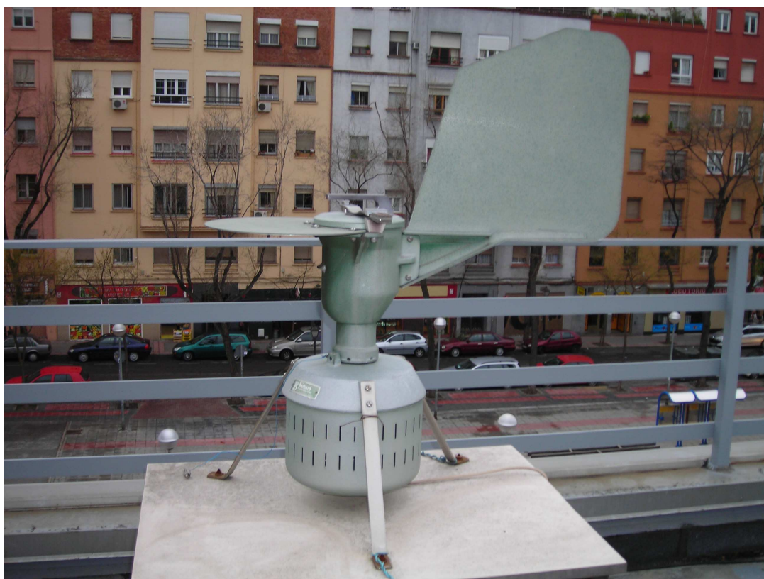
Detalle captador de polen
