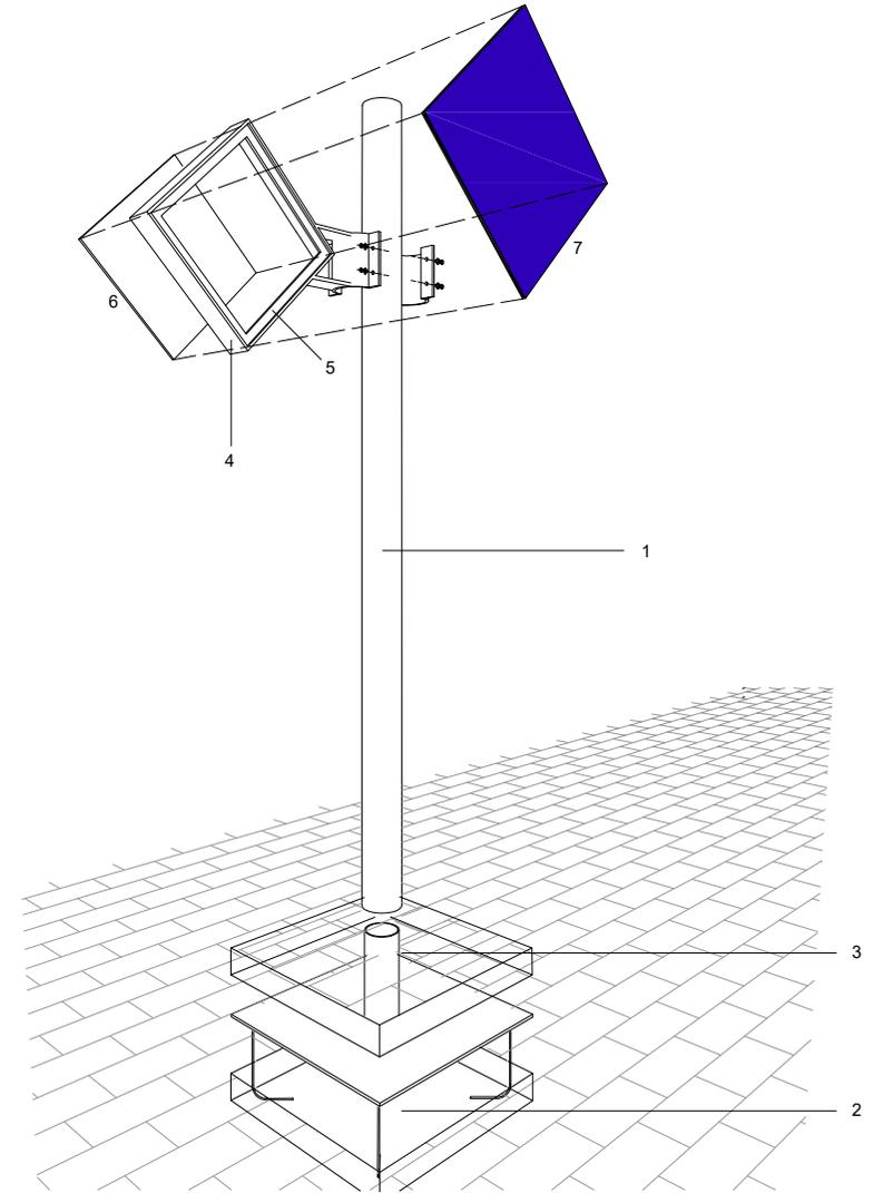
1. Tubo estructural de acero EN 10210-2:2007 de diámetro 159 mm de acero laminado en caliente S275JR según UNE-EN 10025:2020, de espesor 5 mm.
