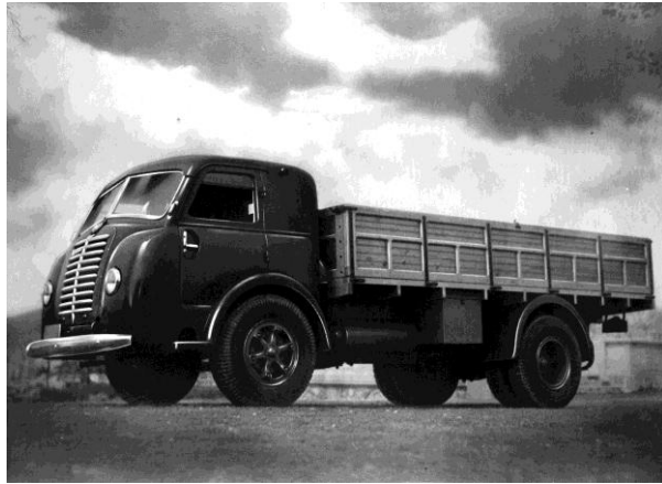
13. INI: ENASA, Camión tipo Pegaso de ocho toneladas de carga con motor de gasolina, 1947-1948. Archivo Histórico del INI
