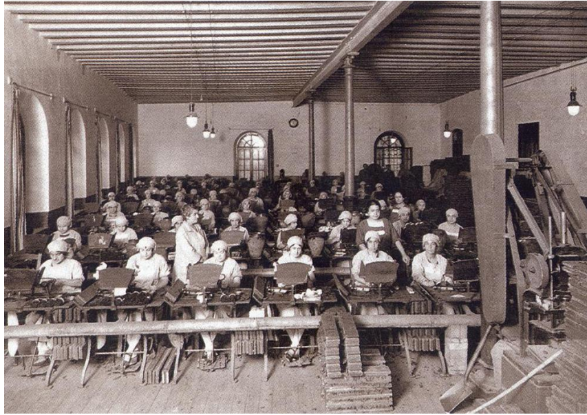
23. Operarias trabajando en mesas de succión en el taller de liado mecánico de cigarros. Fábrica de Cádiz, aproximadamente en 1930. (Tabacalera, S. A. Museo del Tabaco)
