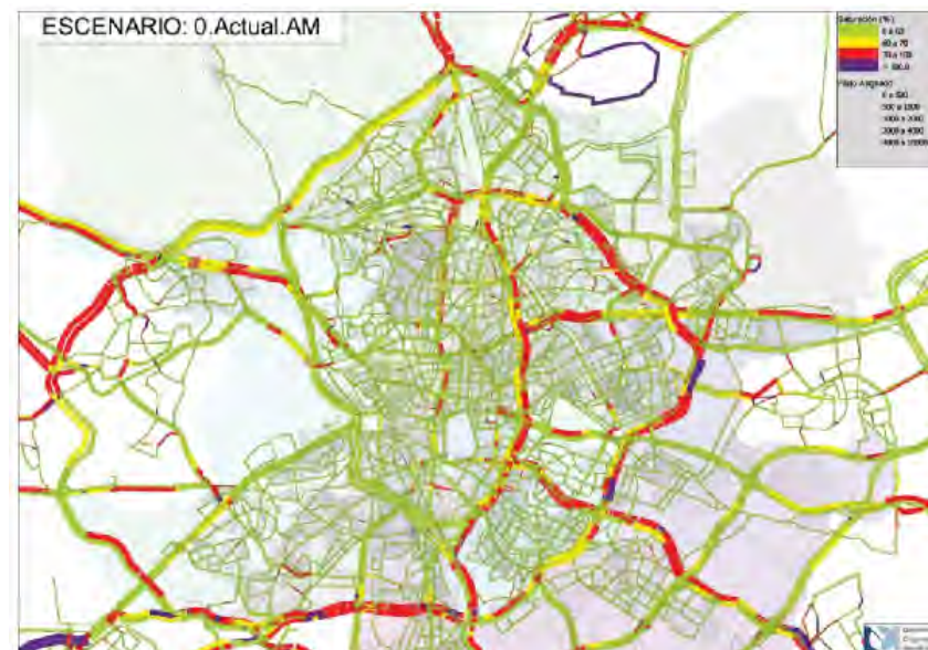
Ilustración 153. Intensidades de tráfico y nivel de saturación (Intensidad/Capacidad) en hora punta de mañana. Situación actual. Fuente: elaboración propia
