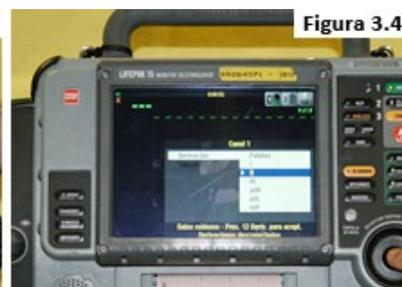
El EKG de 12 derivaciones se puede imprimir en dos formatos (tres canales y cuatro canales) y dos estilos (estándar y Cabrera) que difieren en el orden de impresión de las derivaciones de miembros.
