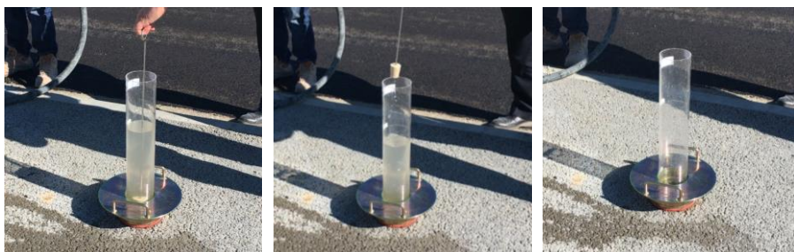
Figura 25. Ensayo con Permeámetro LCS en el hormigón poroso del aparcamiento del Estadio del Atlético de Madrid. Fuente: Green Blue Management
