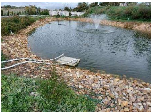
Muestreo de olores en la balsa de lixiviados depurada de Las Dehesas
