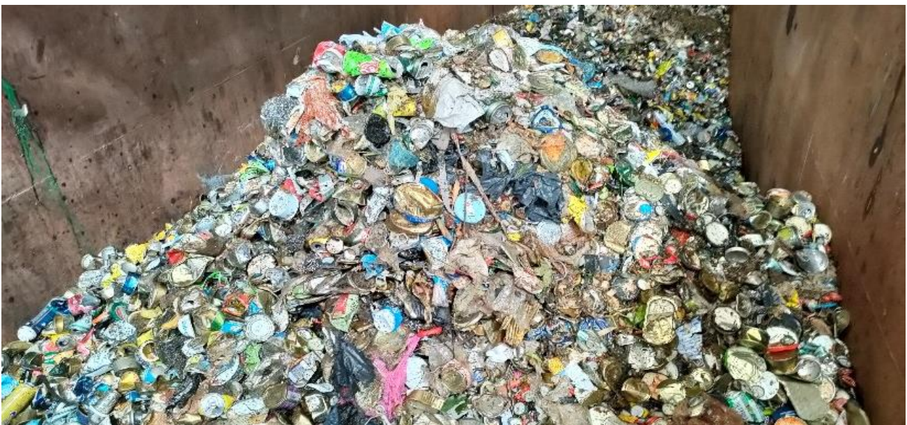
Material férrico recuperado en el pretratamiento de la planta de biometanización de Las Dehesas
