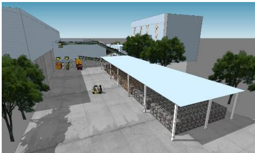
Figura 15. Cubrición de la zona de almacenamiento de balas de subproductos recuperados
