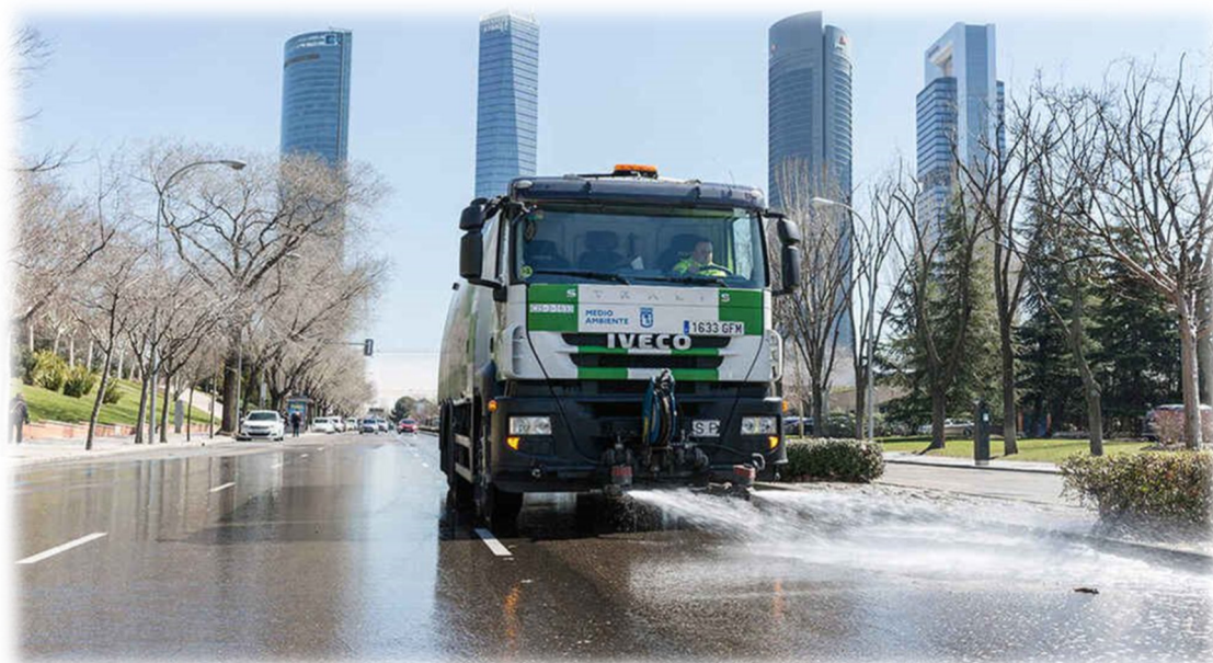
Figura 3: Sistema de baldeo mecánico de la flota de limpieza de Madrid. Fuente: Ayuntamiento de Madrid.
