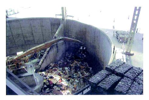
**6.- Incineración de animales muertos y restos de animales.** La capacidad de tratamiento es de 500 kg/hora. Antes de ser incinerados los restos de animales se almacenan temporalmente en una cámara frigorífica a 2°C . Los dispositivos de control instalados en la planta permiten un seguimiento continuo del proceso, tanto en lo que se refiere a las condiciones de combustión, como a la composición de los gases generados y emitidos.
