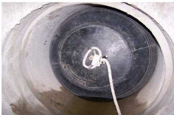
Prueba de estanqueidad de la red de saneamiento mediante llenado de agua y tapado con balones
