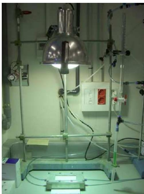
Cámara de ensayo de análisis de actividad fotocatalítica en laboratorio.
