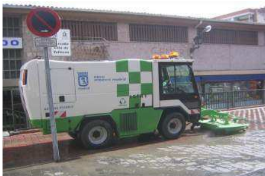
BALDEO MIXTO DE CALZADA (baldeadora con manguera y cepillo)
