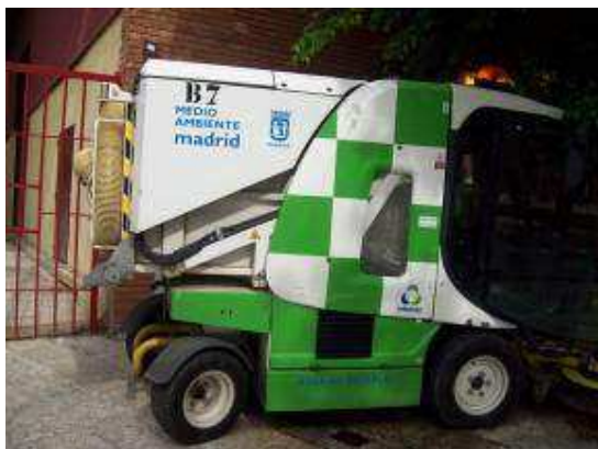
BARRIDO MECÁNICO DE ACERA EN ZONA PEATONAL (barredora de acera)
